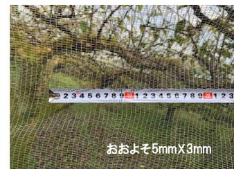
図1 果樹園などの圃場における防災網の寸法例
